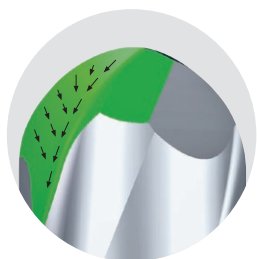
Μηχανοποιημένη (CAD) απεικόνιση της απόστασης μεταξύ των κοπτικών στοιχείων
